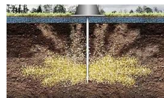
Einbringen von Bodenhilfsstoffen
